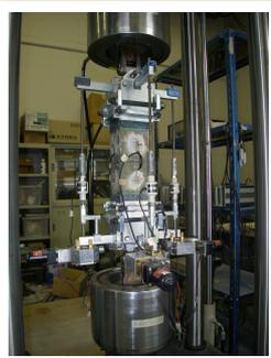
この試験については、本学科在職中にその特殊な実験方法を考案された本学名誉教授秋田宏博士の協力を得て実施しています。コンクリートは通常最大2~3cmの大きさの骨材が含まれる複合材料のため、引張試験を行うには一般に約10cm四方の断面が必要となります。しかし引張に弱く容易にひび割れが発生する材料を、破断するまで真直ぐ引張続けることは非常に困難（曲がったまま引張っては、正しい一軸引張試験とならない）です。
