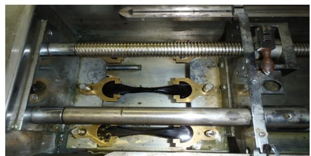
写真-2 伸度試験(試験中)
