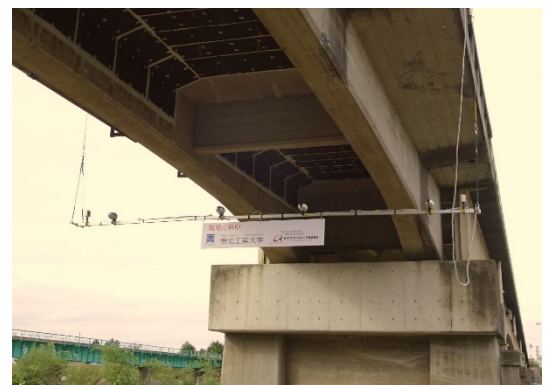
図-1 開発中の橋梁下面点検装置(幸久橋)
