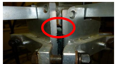
写真-2 炭素繊維シートと治具の滑り
