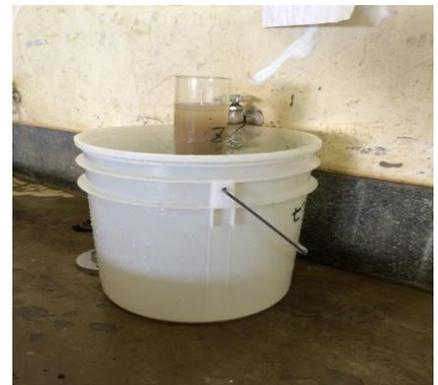
写真2 粒度試験（沈降分析）
