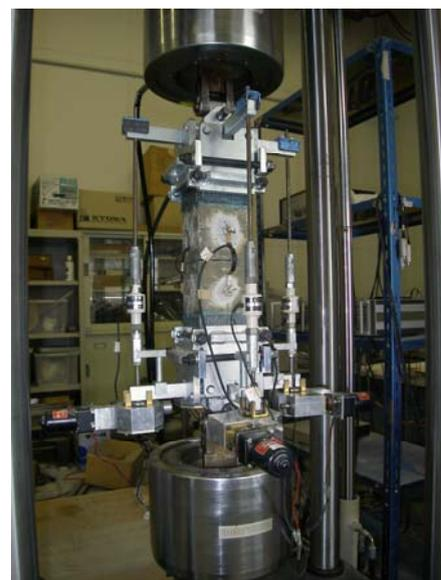
写真-1 直接引張試験の様子
